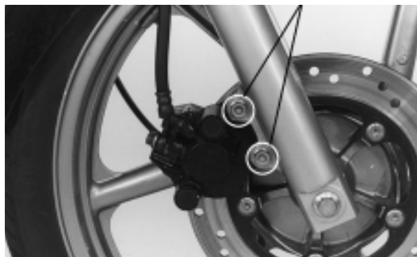
PARAFUSOS DO CÁLIPER
